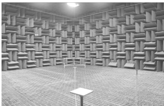
图1 消声室内部结构
