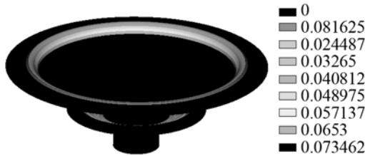
图 7 扬声器在 1 阶固有频率处的 Z 方向振幅 Fig.7 Z direction amplitude of loudspeaker at the first natural frequency
