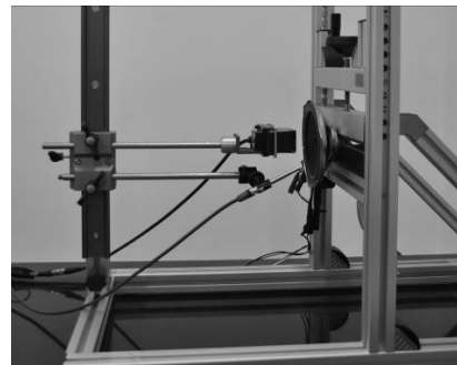
图 4 使用 Klippel R&D 系统测量扬声器 Bl 值 Fig.4 Testing Bl by using Klippel R&D
