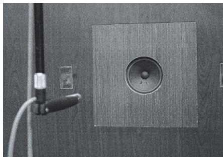
图 11 全消声室内扬声器安装于标准障板上的测量实景图
